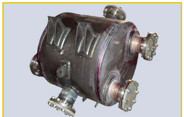
Crude Oil Heater FPSO Cidade de Santos Petrobras
